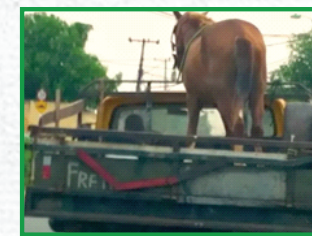
Foto 5: Incorreto - Veículo sem proteção lateral
