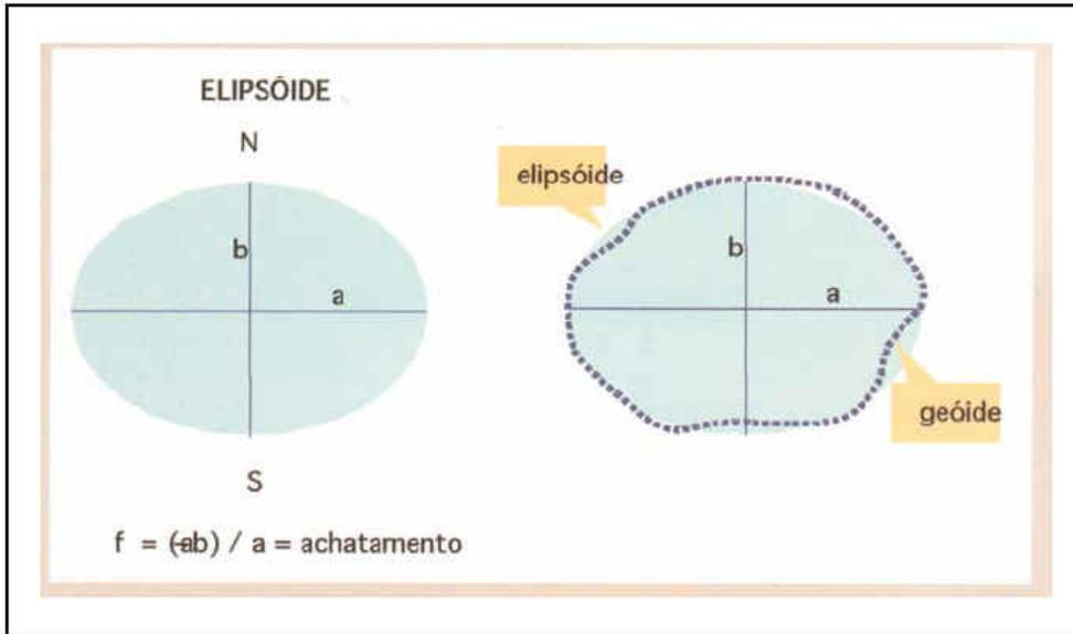
Figura 4. Representação do elipsóide e do geóide.
